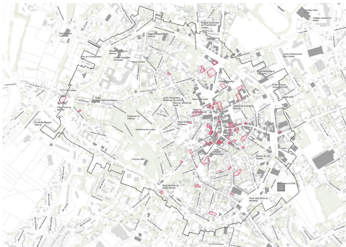
Figure 3 : Cartographie du périmètre de l'OPAH-RU à l'échelle du parcellaire - immeubles repérés dégradés (en rouge)
